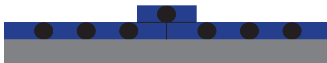
图4b: 边到边平接缝
